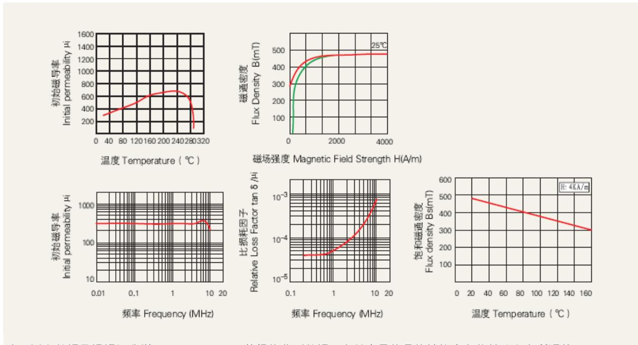
注：以上数据是根据标准样环  $\varnothing 25 \times \varnothing 15 \times 8$  获得的典型数据，有关产品的具体性能会在此基础上有所调整。
