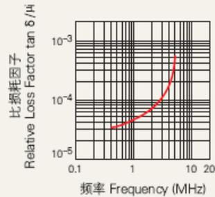
注：以上数据是根据标准样环  $\phi 25 \times \phi 15 \times 8$  获得的典型数据，有关产品的具体性能会在此基础上有所调整。
